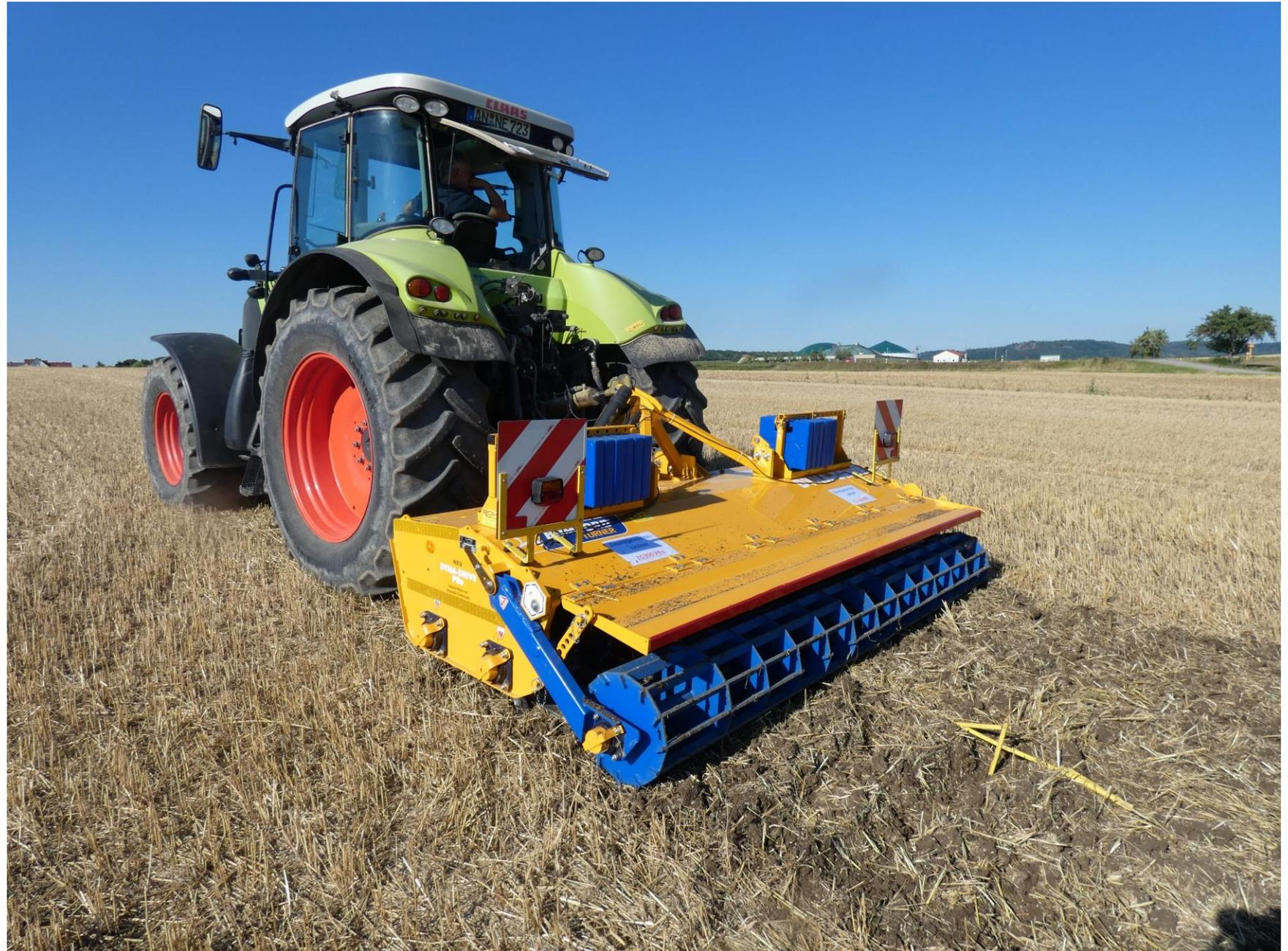
Die Packrahmen fassen pro Seite 12 x 25 kg, das ergibt eine maximale Zuladung von 600 kg
