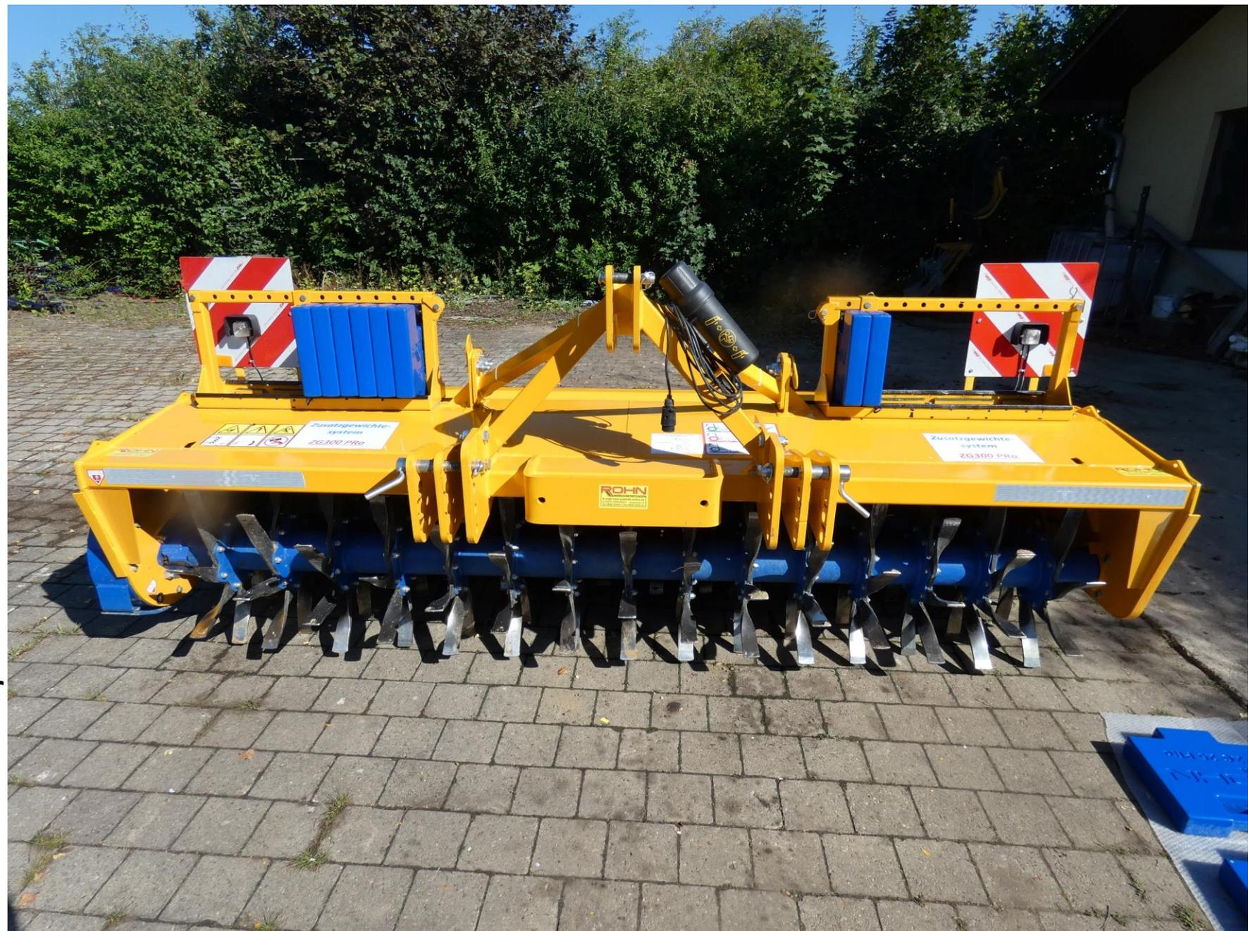
Die Gewichte wurden genau mittig plaziert, damit sich der Zinkendruck bei beiden Rotoren gleichmäßig erhöht.
